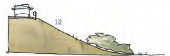
Planteringar görs i bankfot halvvägs upp i slänten för att läka ihop landskapet. Källa: Vägen en bok om vä;
