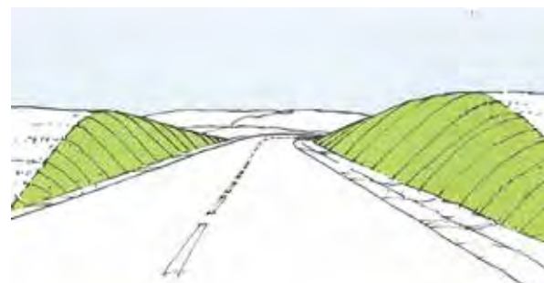
Avrundad slänt. Ett alternativ till propellerbladslänt där platsutrymme är begränsat. Källa: Vägen, en bok om vägarkitektur.
