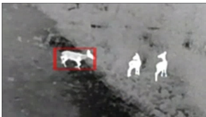
Figur 11. Bild från värmekamera/ detekteringskamera som visar en värmeavbildning av djuret och inte ett tydligt foto. Detta används för detektering vid faunapassage i plan av Trafikerket
