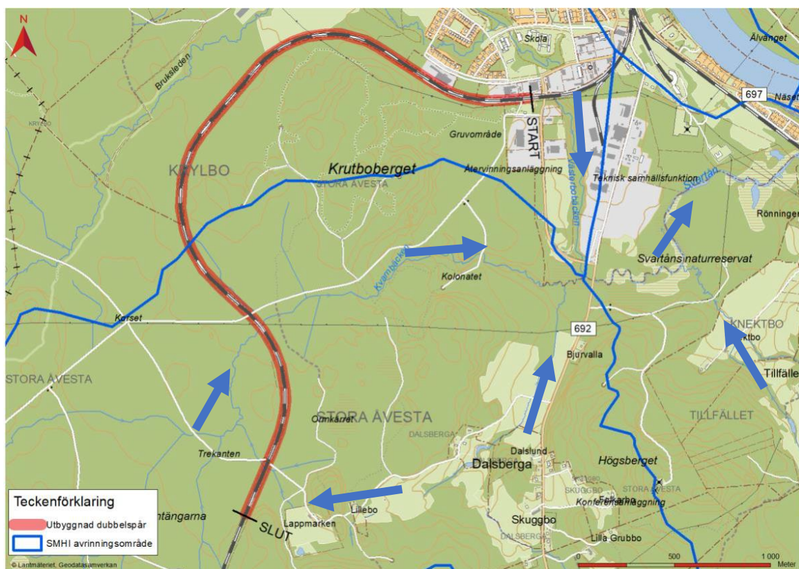
Figur 7. Gräns mellan avrinningsområden enligt VISS (Vatteninformationssystem Sverige) samt den aktuella järnvägssträckan markerad i rött. Blåa pilar visar riktning på vattenflödet.
