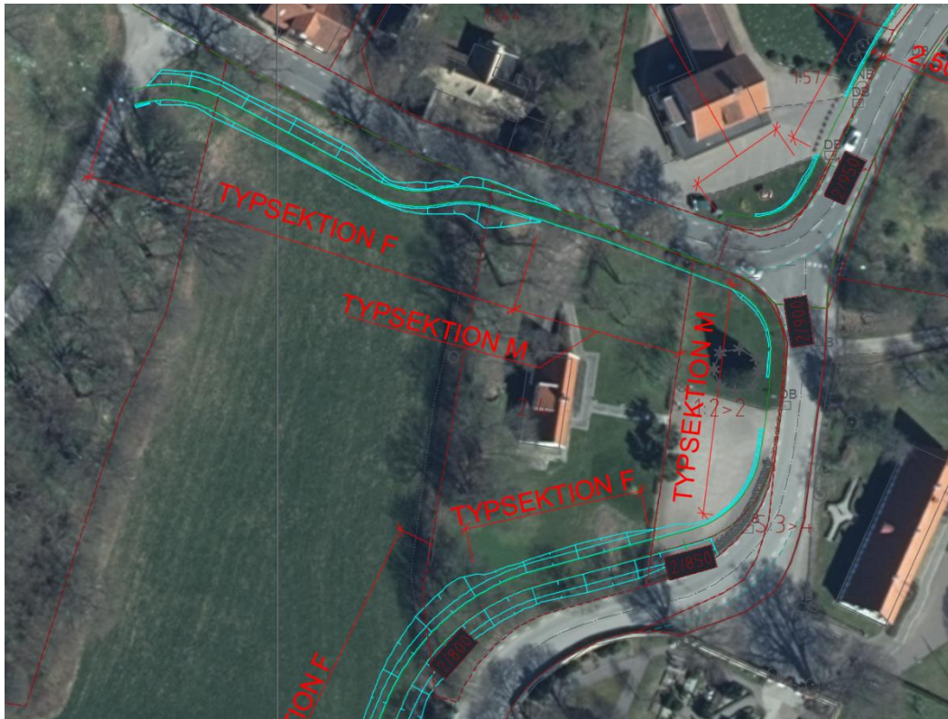
Figur 4. Planerad anknytning av befintliga Kattegattleden till den nya gång- cykelvägen i Brunnby. En placering av GC-vägen väster om väg v.1444 vid Brunnby kyrka minskar intrång på biotopskyddad stenmur samt jordbruksmark bakom prästsekreariatet.
