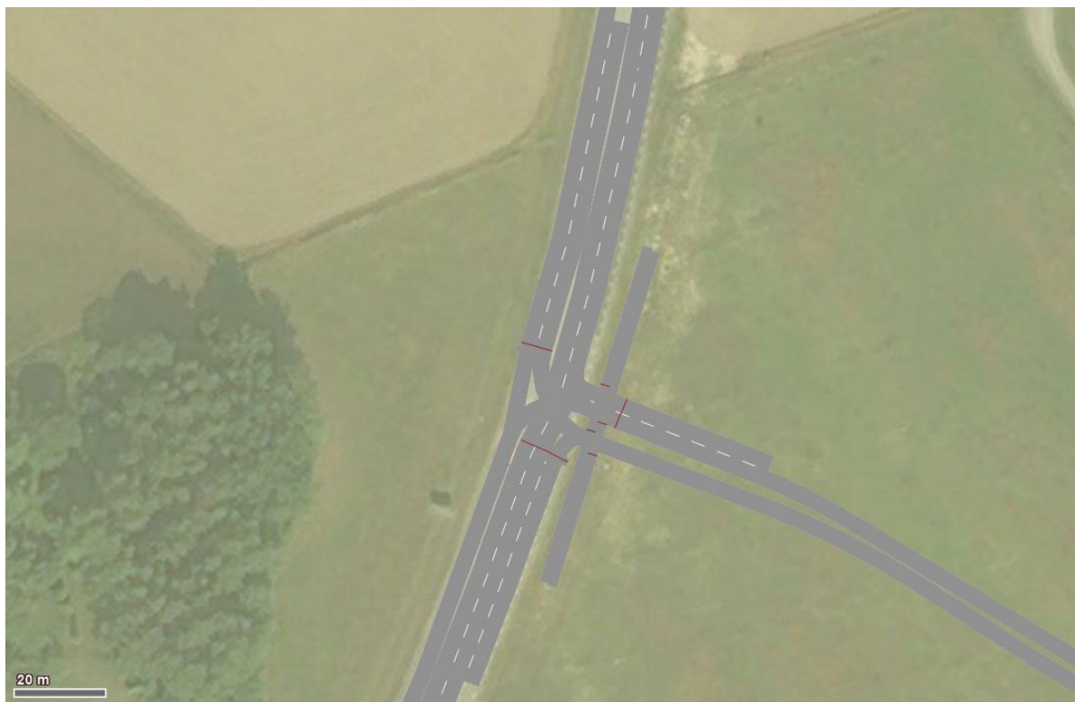
Figur 9. Väg 290/Kometvägen som signalreglerad korsning
