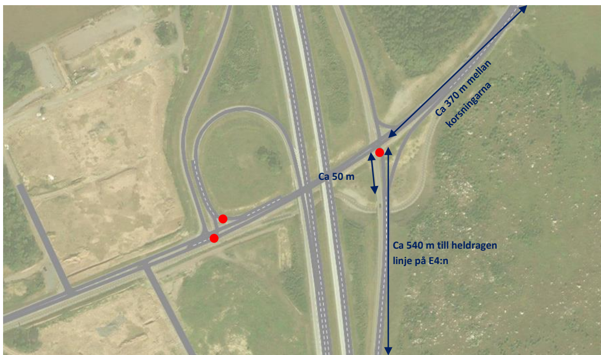
Figur 10. Köräknare vid trafikplats Fullerö. Avståndet mellan korsningen med Kometvägen och avfartsrampen är cirka 370 meter. Avståndet till heldragen linje på E4:n på avfartsrampen är cirka 540 meter och avståndet från väg 290 till GC-tunneln är cirka 50 meter.
