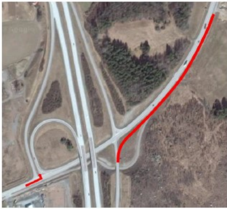
Figur 23. Utredningsalternativ 1 innebär att ett vänstersvängskörfält anläggs på väg 693 vid västra rampanslutningen och att ett högersvängsfält anläggs från bron över gång- och cykelvägen. Högersvängsfältet övergår i ett cirka 300 meter långt extra körfält längs väg 290 mot Störvrete.
