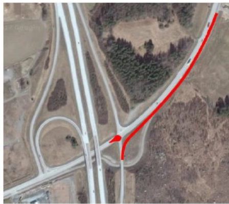
Figur 24. Utredningsalternativ 2 innebär att en droppformad rondell läggs in i korsningen med ramperna på östra sidan av trafikplatsen. Motorvägsavfarten i norrgående riktning har en fri högersväng enligt utredningsalternativ 1 och väg 290 fortsätter i två körfält österut mot Störvrete.
