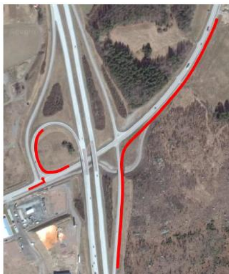
Figur 25. Utredningsalternativ 3 innebär ett extra körfält längs både hela avfartsrampen från Uppsala och längs väg 290 fram till planerad cirkulationsplats, ett vänstersvängskörfält på väg 693 vid västra rampanslutningen och ett högersvängskörfält och dubbla körfält på första delen av påfartsrampen mot Uppsala.
