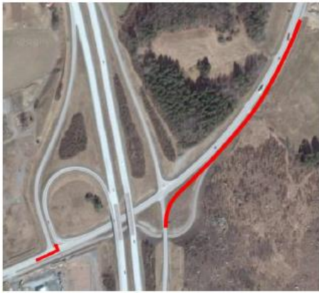
Figur 23. Utredningsalternativ 1 innebär att ett vänstersvängskörfält anläggs på väg 693 vid västra rampanslutningen och att ett högersvängsfält anläggs från bron över gång- och cykelvägen. Högersvängsfältet övergår i ett cirka 300 meter långt extra körfält längs väg 290 mot Storvreta.
