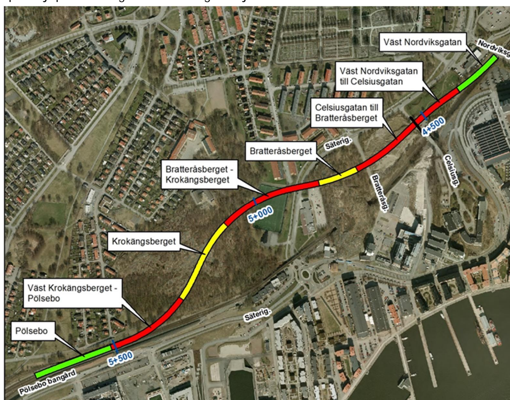
Figur 5-1. Områdesindelning enligt nedanstående beskrivning. Färgerna visar: Grönt=tråg, Röd=betongtunnel och Gul=tunnel i berg
