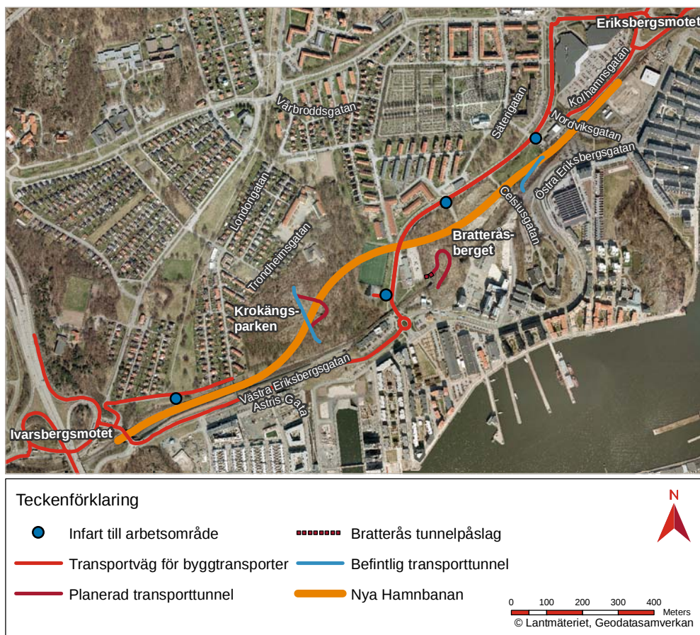
Figur 10.5 Möjliga transportvägar och anslutningspunkter för byggtrafik.
