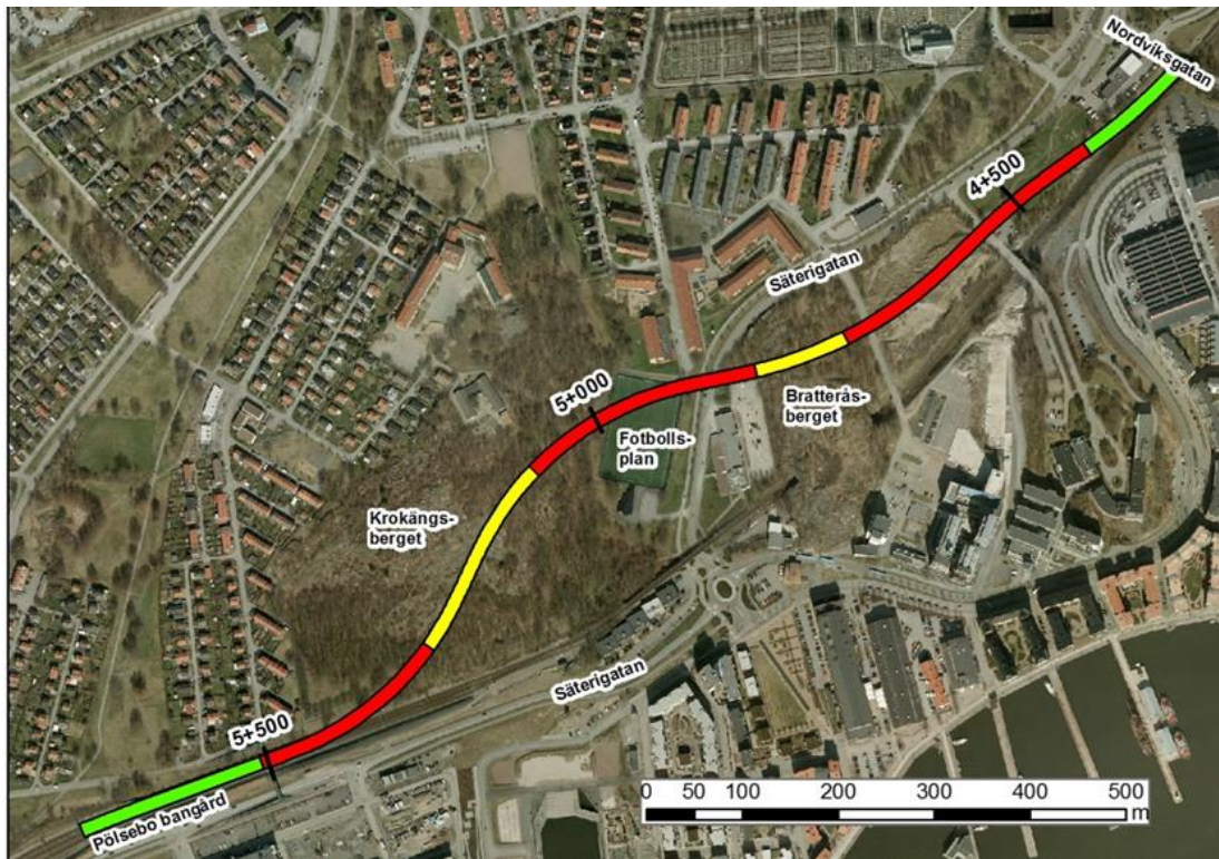
Figur 1. Planerad utbyggnad av Hamnbanan, delen Eriksberg – Pölsebo. Gult visar spårets utsträckning i bergtunnel, rött betongtunnel och grönt tråg/stödkonstruktion.
