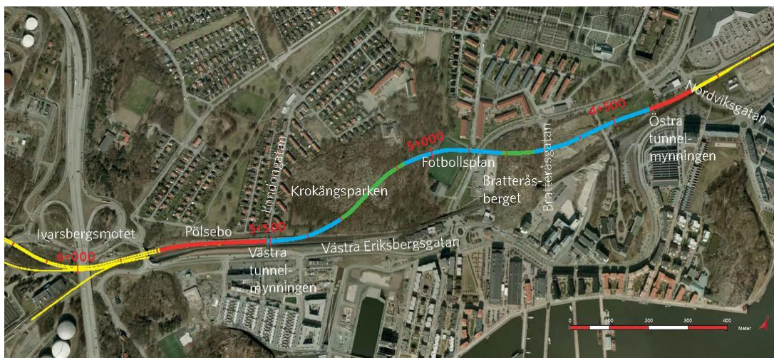
Figur 2 Planerad utbyggnad av Hamnbanan, delen Eriksberg – Pölsebo. Gult visar spårets utsträckning i jordskäring, rött tråg/stödkonstruktion, blått betongtunnel och grönt bergtunnel.
