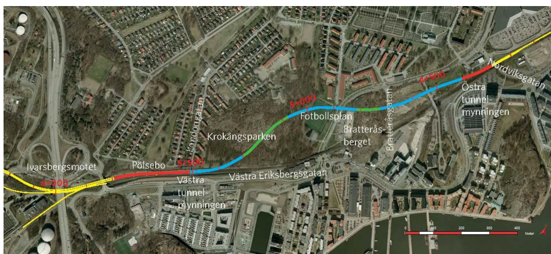
Figur 4 Planerad utbyggnad av Hamnbanan, delen Eriksberg – Pölsebo. Gult visar spårets utsträckning i jordskärning, rött tråg/stödkonstruktion, blått betongtunnel och grönt bergtunnel.
