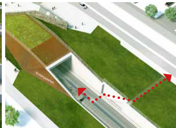
Utrymningsväg vid västra tunnelmynningen
