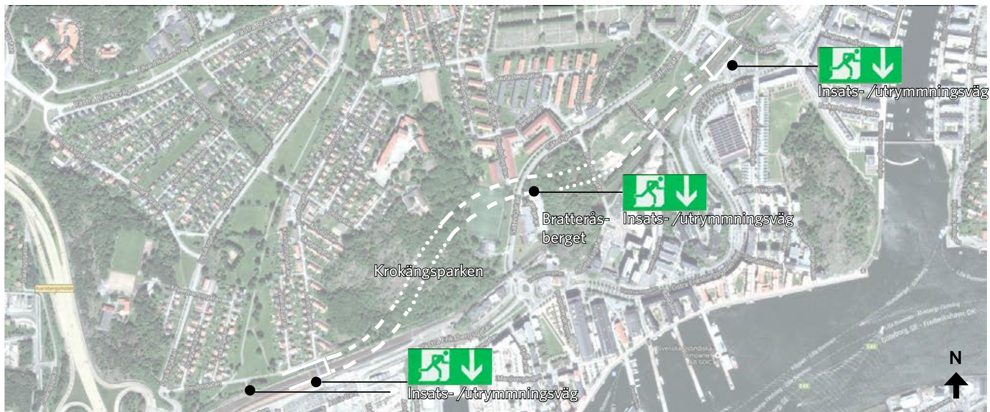
Utrymningsvägar från järnvägstunnel.
