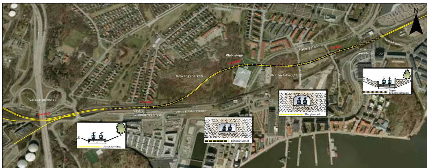
Figur 27. Hamnbanans sträckning Eriksberg-Pölsebo inklusive byggmetod för olika delsträckor
