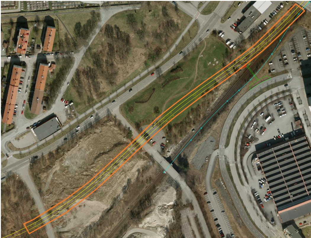
Figur 4.3 Illustrativ bild som visar det delområde vid Säterigatan inom vilket Hamnbanans nya sträckning kommer att gå i betongtunnel (orange markering).
