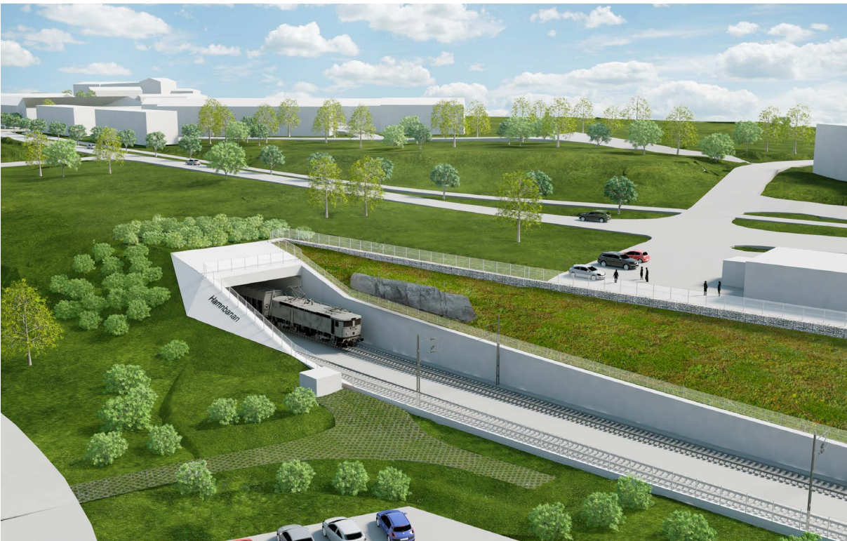
Figur 8.3.5. Gestaltning för den östra tunnelmynningen vid Bratteråsberget, vy från sydost.
