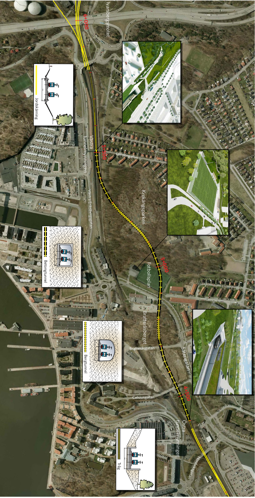
Figur 6.1.1. Ortfoto med illustration över hur nya Hamnbanan kommer att se ut imed val av linje och konstruktionstyp för olika delar. XXXX innebär längdmatning i kilometer.
