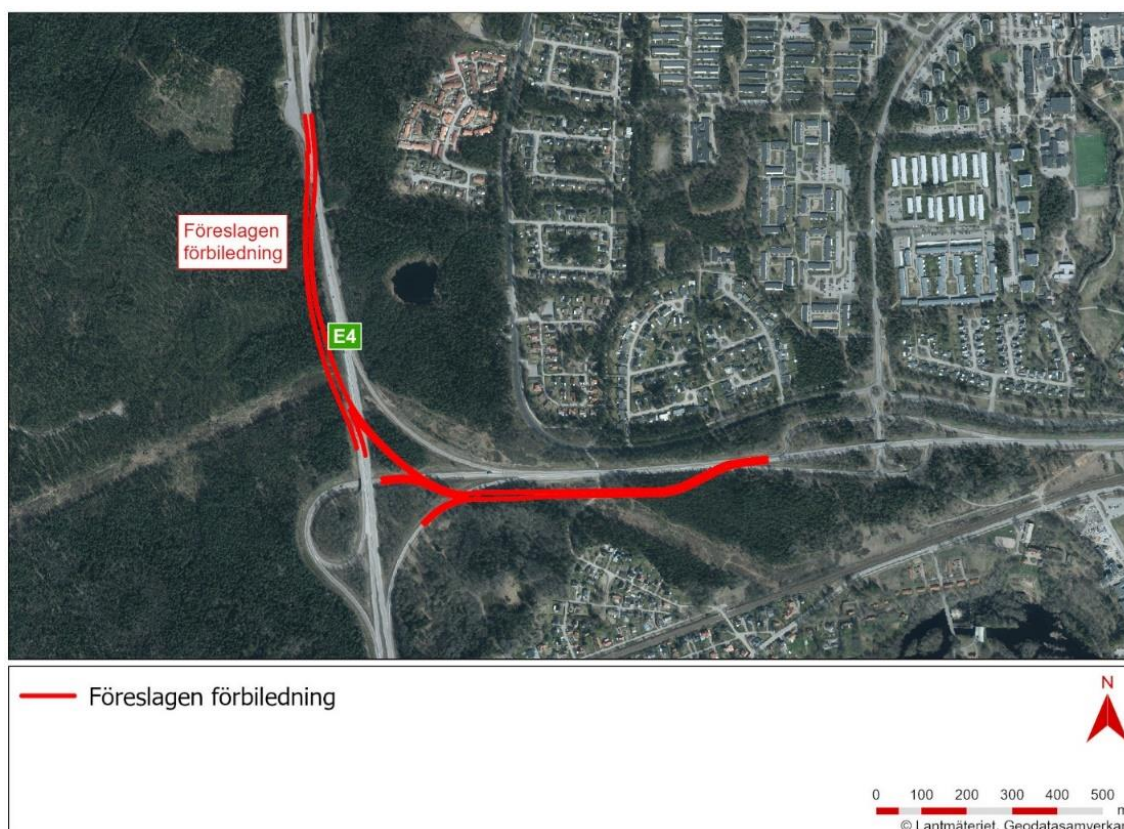
Figur 65. Förbiledning av Hamnleden och E4 under byggtid.
