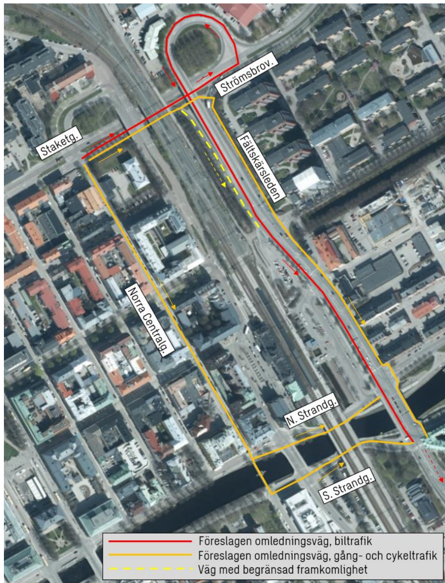
Figur 60. Omledning av södergående trafik på Fältskärsleden.
