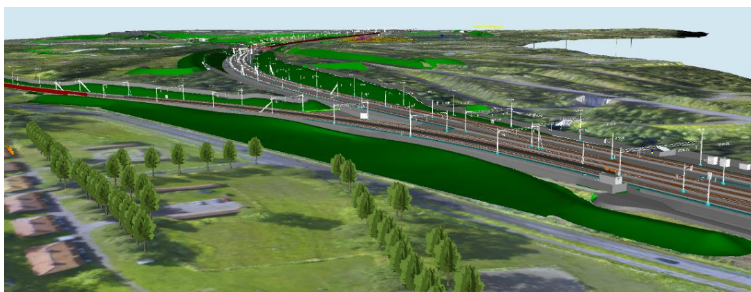
Figur 26. Bullerskyddsvall på södra sidan om järnvägen. Vy mot nordväst, Tolvfors nedtill. Färgerna i illustrationen motsvarar inte den färdiga anläggningen. Figur hämtad ur: samordningsmodell, version 30 november 2023.
