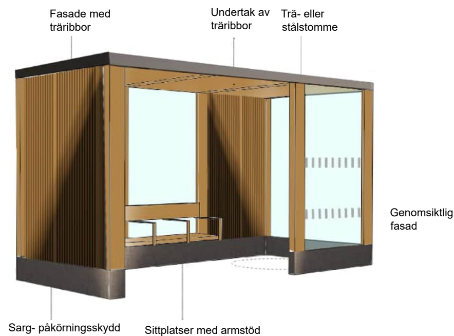
Figur 56. Illustrativ principskiss för väderskydd. Inslag av träribbor liksom stationens entrébyggnader.
