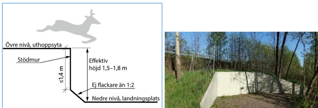
Figur 25 till vänster. Principutformning av viltuthopp. Bildkälla VGU (Trafikverket, 2024).
