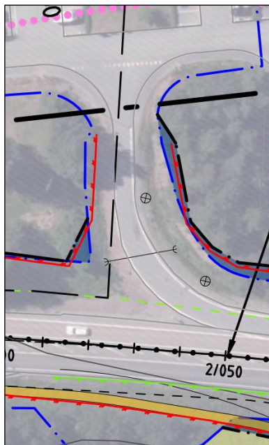
Figur 24. Det behövs en öppning i stängslet vid den norra infarten till rastplats Skuleberget och Naturum. Viltstängslet, markerat med rött streck i figuren, vinklas in längs med infarten. Modifierat utsnitt från illustrationskarta 101T0504. Norr är åt höger i figuren, väster uppåt och öster nedåt.
