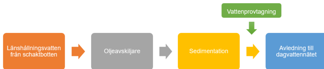
Figur 2 Schematisk skiss över reningsystem vid hantering av länshållningsvatten från schakt.
