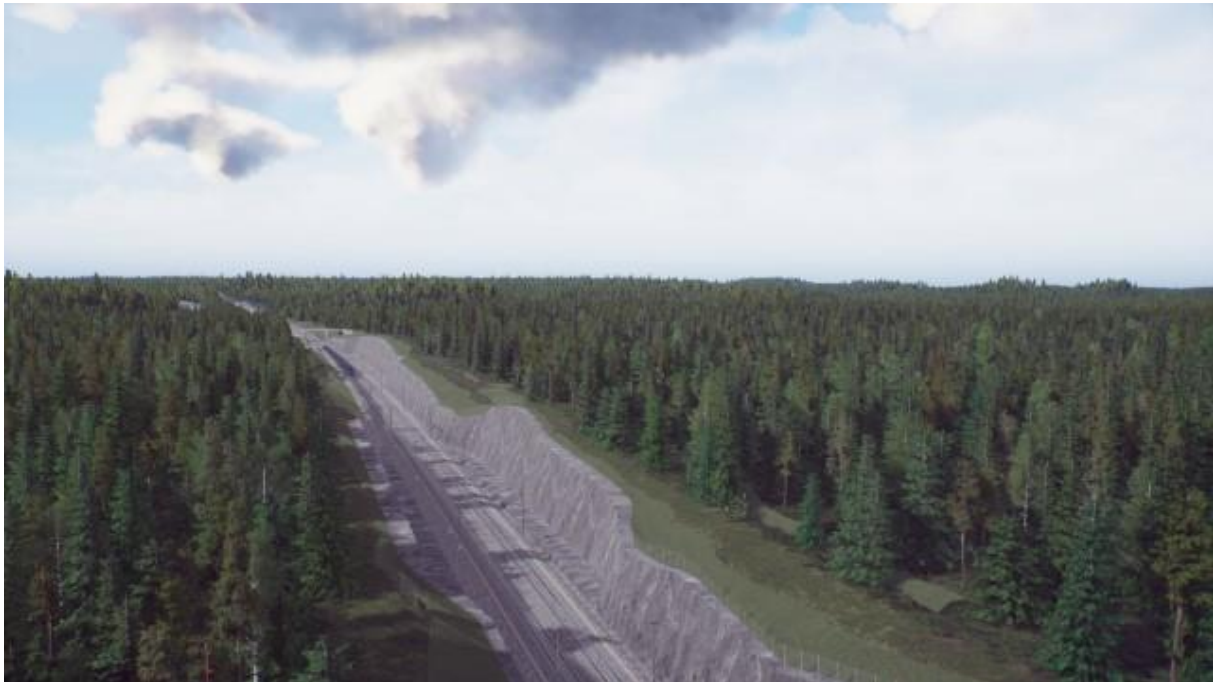
Figur 40. Planbild vid km 87+000–87+700 Planerade tätvallar illustreras som ljusgröna långsträckta fält till höger om järnvägen i bilden.
