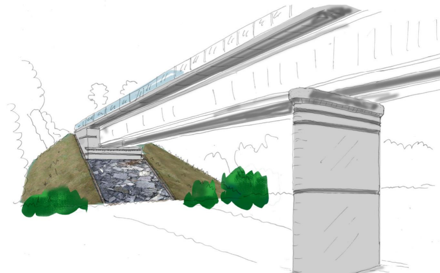
Brons anslutande koner i gräs med lättskött yta av natursten under brofästena. Avrundade skivstöd och frontmurar med reliefmönster. För att underlätta passagen för djurlivet planteras buskage som skydd i anslutning till brokonerna.
