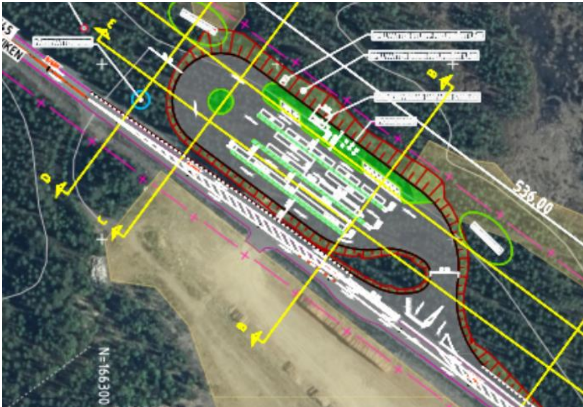
Figur 8 Förkastat alternativ med gemensam in- och utfart emot söder.
