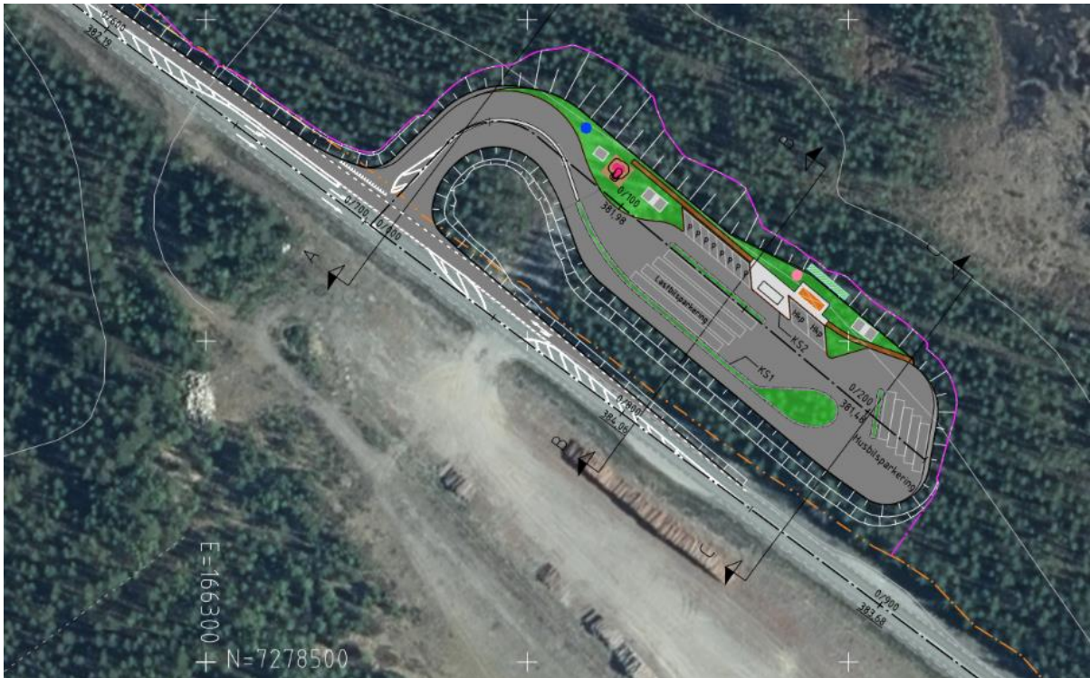
Figur 6. Utformning av det valda alternativet med gemensam in- och utfart mot norr, se också separat illustrationskarta
