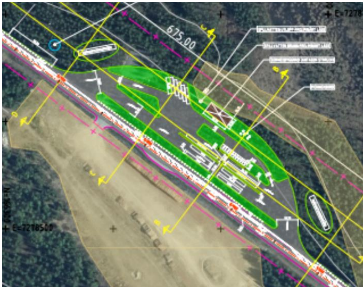
Figur 7 Förkastat alternativ med separat in- och utfart
