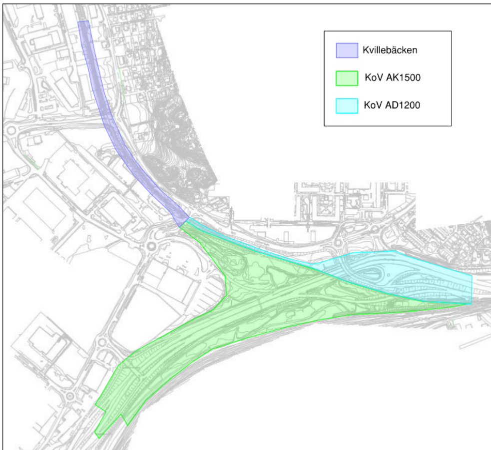
Figur 4. Avrinningsområden inom utredningsområdet för befintlig situation, indelade efter utlöpp/anslutningspunkt.
