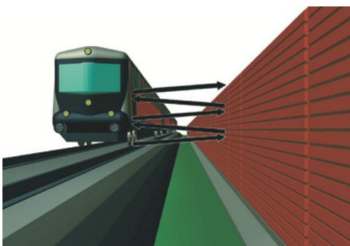
Figur 9. Ljudreflektion mellan tåg och ej ljudabsorberand bullerskyddsskärm.
