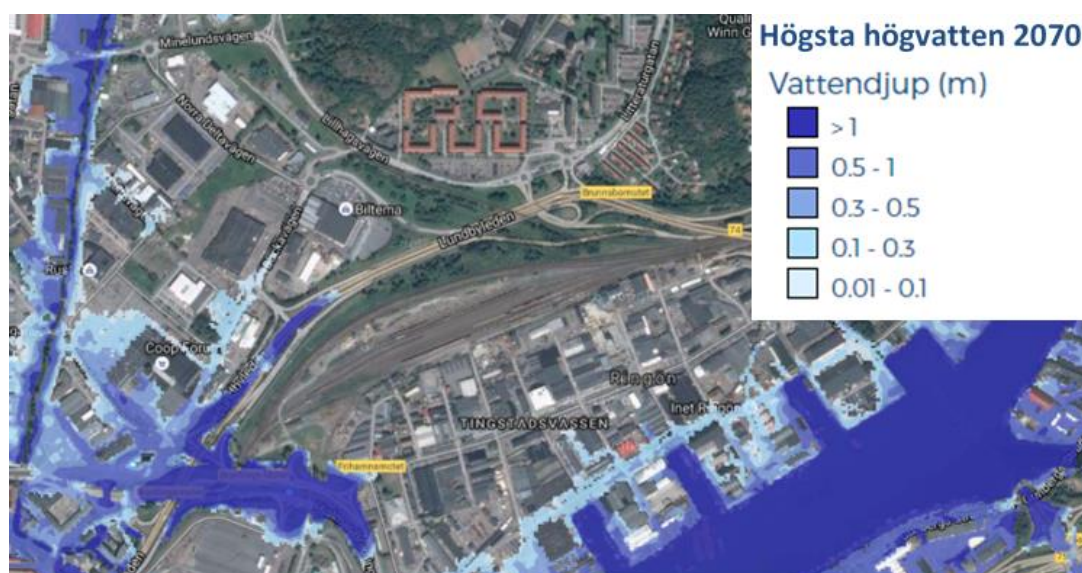
Figur 18 Översvämningssimulering för scenariot 2070 vid en havsnivåpeak med 200 års återkomsttid (Källa: Vatten i staden).
