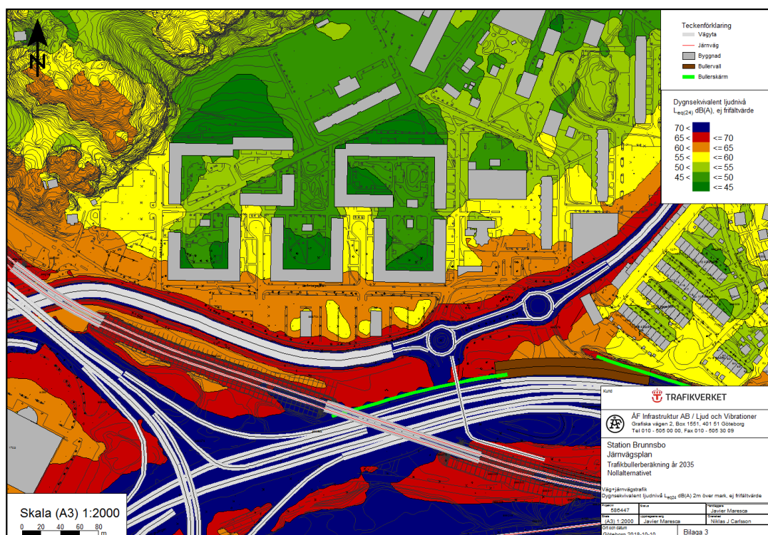
Beräknade ljudnivåer efter ombyggnad av Lundbyleden och Bohusbanan, redovisas i Figur 11. I och med de föreslagna bullerskyddsåtgärderna bedöms möjligheterna att uppnå Trafikverkets riktlinjer 9 förbättras.
