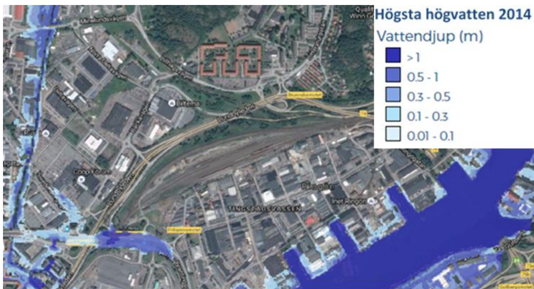
Figur 17 Översvämningsmodellering gjord år 2014 för en havsnivåpeak med 200 års återkomsttid i Göta älv (Källa: Vatten i staden).
