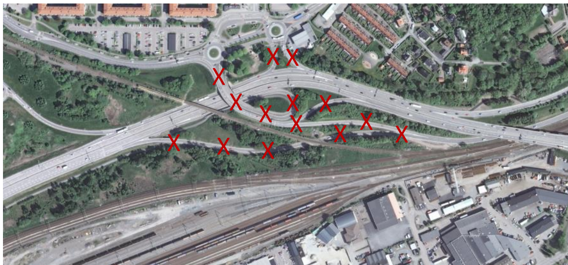
Figur 21 Översikt för Brunnsbomotet. Röda kryss markerar de vägdelar som ska rivas.
