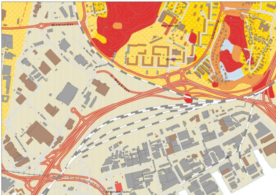
Figur 16 Kartan visar jordarter i markytan där grått är fyllnadsmassor, rött är berg, gult är lera, orange är sand eller grus och ljusblått är morän.
