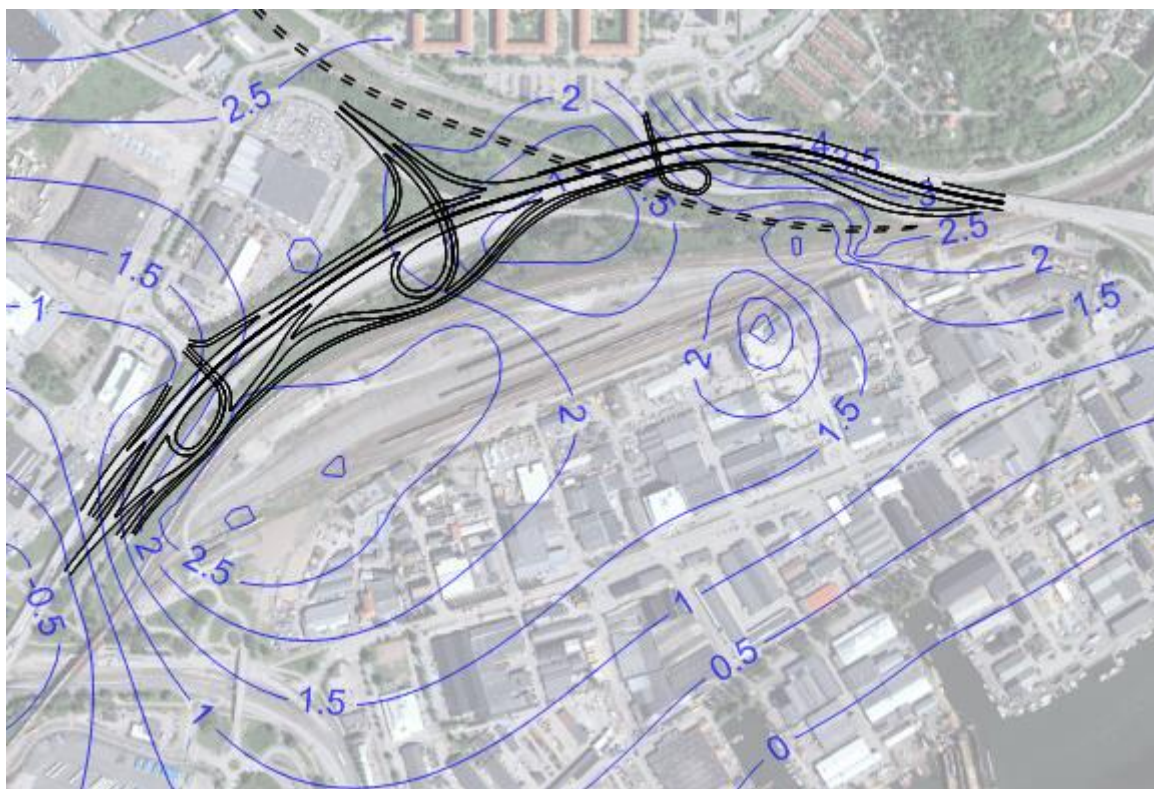
Figur 17 Tolkade grundvattennivåer från oktober 2014. Älvens vattenstånd mäts vid "TK Tingstad" och har extrapolerats till punkterna markerade "Göta älv". Höjder angivna i RH2000.
