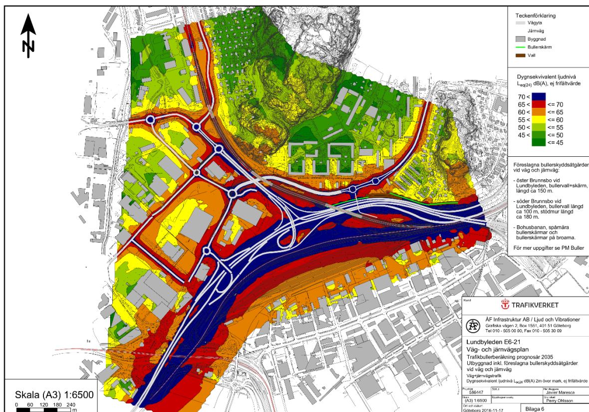
Figur 28 Ljudutbredningskarta som redovisar dygnsekvivalent ljudnivå i dBA efter ombyggnad av Lundbyleden och Bohusbanan. Planerade bullerskyddsåtgärder i form av vallar redovisas som bruna linjer och bullerskärmar som gröna linjer. Utöver vallar planeras spärrnära bullerskyddsåtgärder längs Bohusbanan. Dessa är inlagda i beräkningen men syns inte i kartan.
