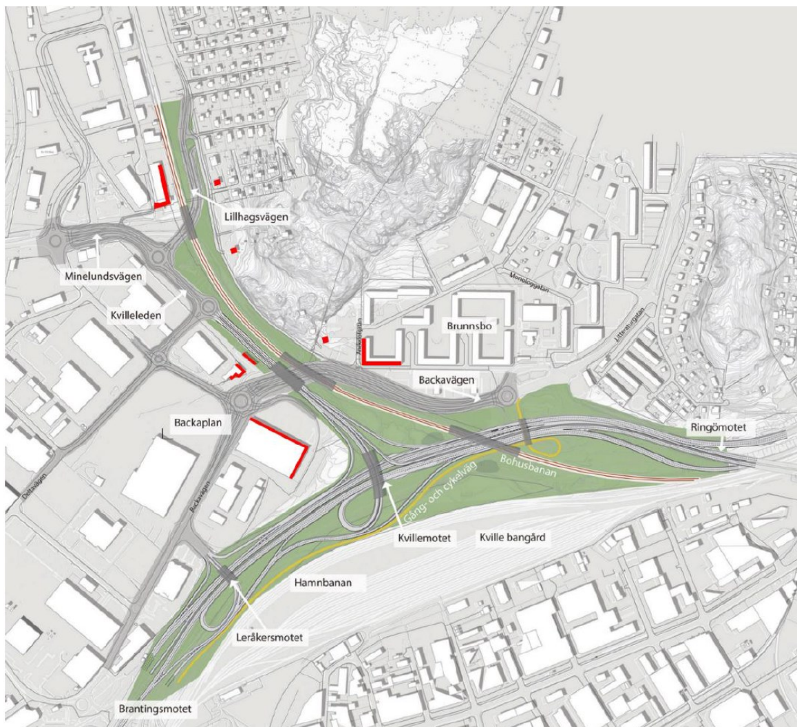
Figur 36 Resultat av bedömning. De byggnader, vid vilka risk för komfortstörande vibrationer överskridande 1,0 mm/s föreligger under byggskedet är markerade i rött.
