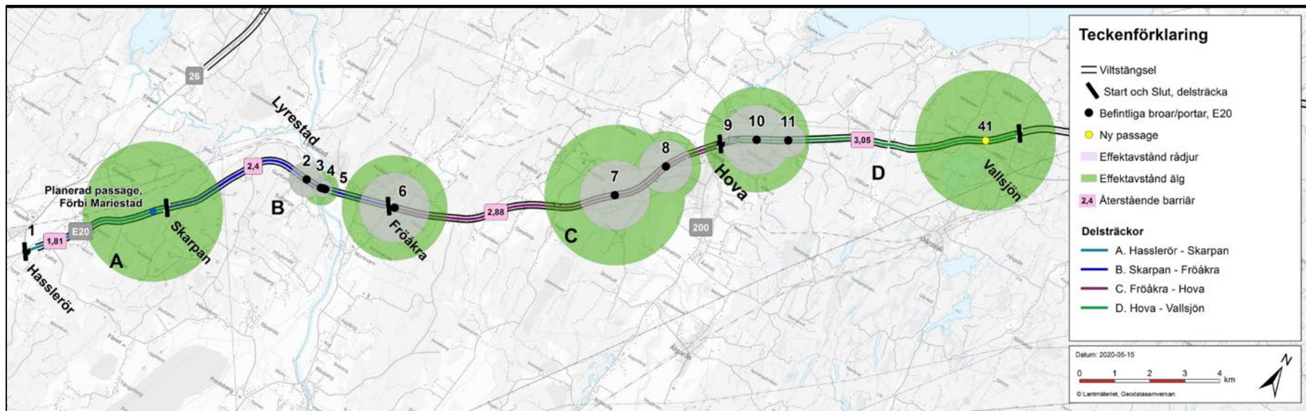
Figur 30. Föreslaget läge (Id 41) för ny faunapassage vid Vallsjön med bedömt effektavstånd efter åtgärd. Siktskydd föreslås på befintliga portar nr 2 och 8. Stängselåtgärder vid port 3 och 6.
