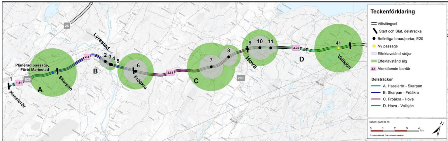
Figur som översiktligt visar åtgärdsförslagen med ny faunapassage i läge 41, samt faunaåtgärder på befintliga portar vid id 2 samt id 8. De mindre åtgärderna som färister etc finns inte upptagna i denna figur. Faunabron vid Skarpan på delsträcka A byggs inte av detta projekt. Vid Hova finns redan en byggd faunabro som blev klar 2019 (Id 7). Projektet tillgodogör sig dessa två passager vid helhetsbedömningen av nyttan av passager på aktuell sträcka Hasslerör-Vallsjön. I figuren visas inte bortvalda alternativ.
