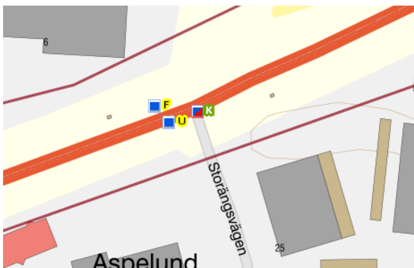
Figur 4.5. Trafikolyckor längs väg 49 vid korsning med Storängsvägen. U = upphinnandeolycka, K = olycka med korsande fordon, F = olycka mellan fotgängare och motorfordon. Källa: STRADA
