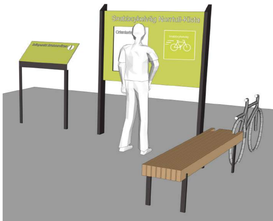
Figur 123. Inspirationsbilder: En möbelserie med genomgående temafärg för snabbcykelvägen. Informationskyltar med översiktsskarta och målpunkter som placeras vid exempelvis start och slutpunkt för snabbcykelvägen samt i samband med cykelpumpstationer. Infopunktskyltar med kultur- och naturinformation kan placeras vid utsiktspunkter som till exempel Brunnsviken. Bänk med integrerat cykelställ.
