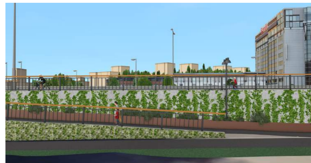
Växtvägg med såkallad "butong" på stödmur samt klättrväxter som slingrar sig upp på vajrar på stödmur.
