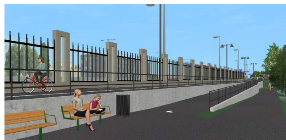
Figur 96 & 97. Stödmurar och ramp söder om Bergshamraleden vid Brunnsviken ca 3/230-3/290. Murarna föreslås i naturmaterial, blocksten av granit för att samspela med Brunnsvikens park- och naturmiljö. Se sida 120-123 för mer information.
