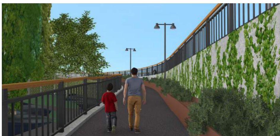
Figur 94. Ramp på norra sidan om Bergshamraleden som leder upp till den nya gång- och cykelbron vid ca 3/790. Stödmurar i betong med planteringslåda i corténstål. Betongmurens väggar kläs med vajrar för klättrväxter som skyddar mot klotter och ger ett trivsammare miljö. Se sida 138-141 för mer information.
