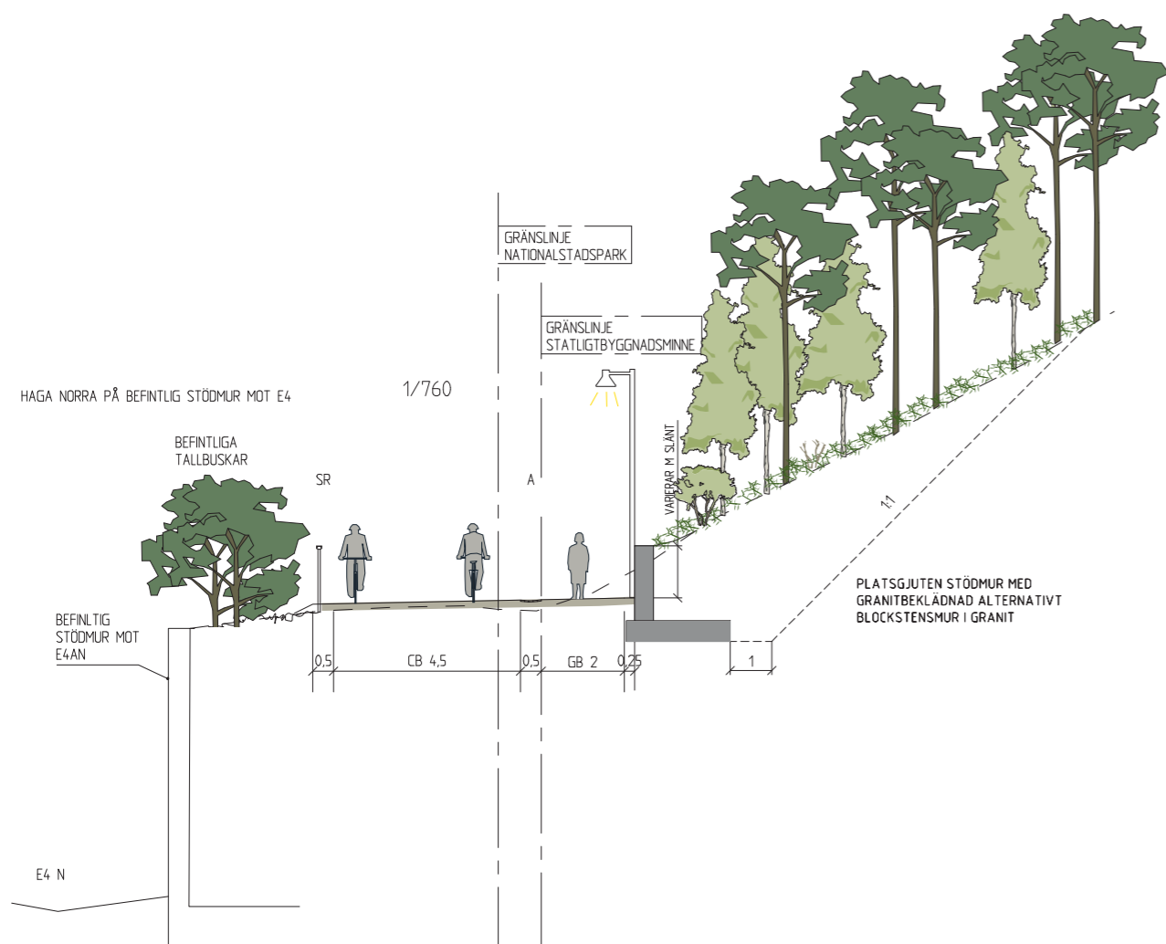
Figur 87. Stödmur vid Haga Norra 1/700. Vegetationen som växer bakom stödmuren måste tas ned i och med anläggandet av muren. Spont kan med fördel användas för att kunna spara så många träd som möjligt. Nyplantering av liknande träd ska ske för att läka ihop landskapet efter anläggningen av muren. Träden kommer succesivt att växa till sig, men tar sin tid. Situationen på sektionen visar på när träden vuxit till sig.
