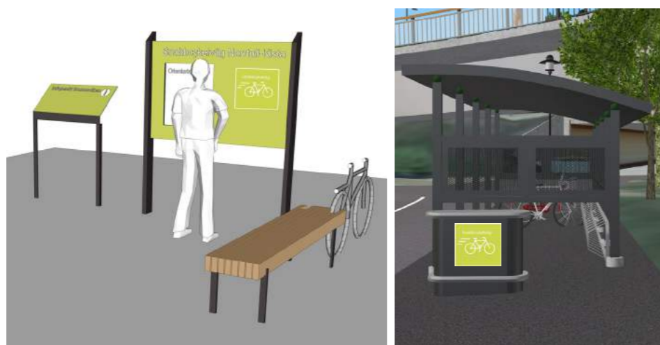
Figur 53 och 54. Skisser som visar inspiration till orienteringsskyltar, infoskyltar, bänk med cykelställ, cykelställ med tak och cykelservice med luftpump och cykelverktyg placeras tillsammans vid servicestationer/rastplatser längs med sträckan. Servicestationerna/rastplatserna placeras i närheten av snabbcykelvägen vid strategiska punkter där det finns t.ex. anslutningar till andra cykelvägar, kollektivtrafik eller vid vackra utsiktspunkter.
