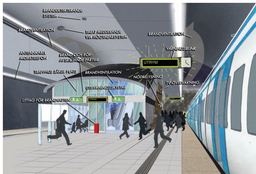
Illustration av säkerhetssystem på station under mark, för station i Kista och för täckt station i Sundbyberg.
