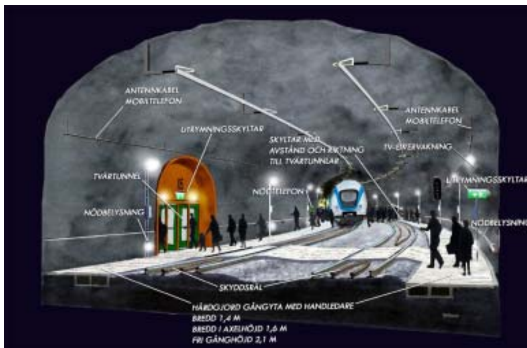
Figur 25 - Illustration av säkerhetssystem i spårtunnel.
