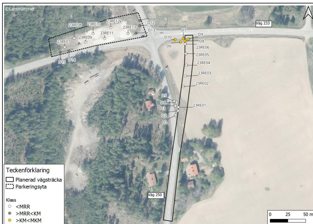
Figur 15. Situationsplan med klassificerade analysresultat. Jordprov uttagna med geoteknisk borrhör med skruvborr är märkta som 23RE01-23RE13. Vägdikesprover har tagits vid tre olika delsträckor och slagits ihop till ett samlingsprov per delsträcka D1-D5, D6-D10 och D11-D15.
