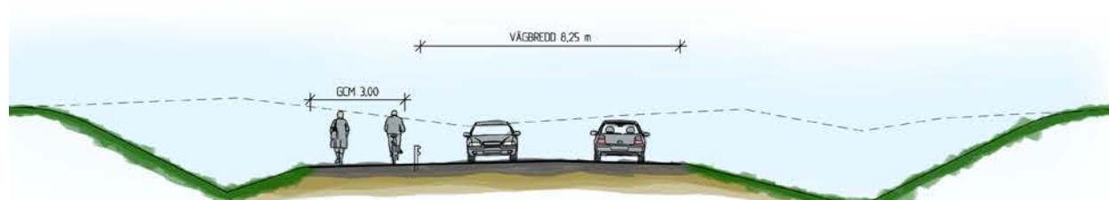
Figur 4.3 Ny sträckning av väg 913 där vägen går i skärning mot vägporten. Gång-, cykel- och mopedvägen skiljs från vägen med ett räcke. Norr är till vänster i bilden.
