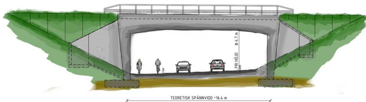
Figur 4.4 Korsningen mellan väg 913 och Lommabanan. Vägen och gång-, cykel- och mopedvägen går under järnvägen i en vägport. Norr är till vänster i bilden.
