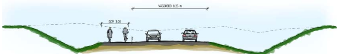
Figur 4.2:3. Principsektion för ny sträckning av väg 913 där vägen går i skärning och gång- och cykelvägen skiljs från vägen med ett räcke.
