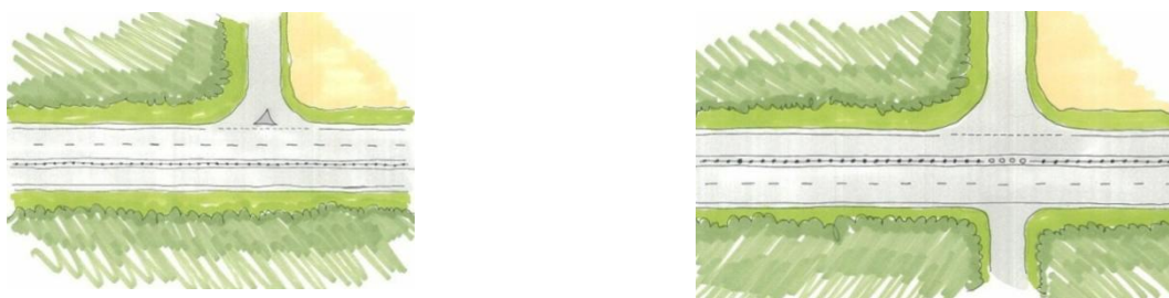
Illustrationer: Exempel på "Höger in-Höger ut"-lösning (t v) och traktoröverfart (t h).
