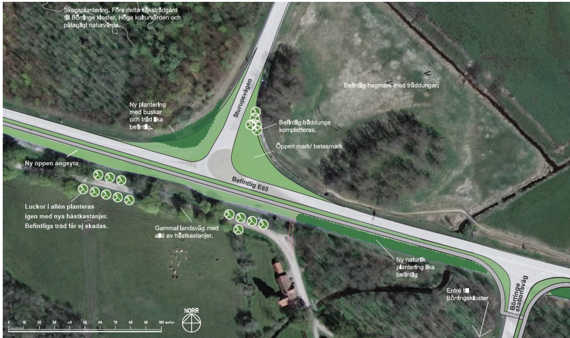
Figur 42. Översikt befintligt E65 och väg 813 (Södra Sturupsvägen). Ny trevägskorsning och föreslagen nyplantering. Återplantering som kompenserar avverkning på allén vid Fjällfotavägen och allén vid Perstorps gård.
