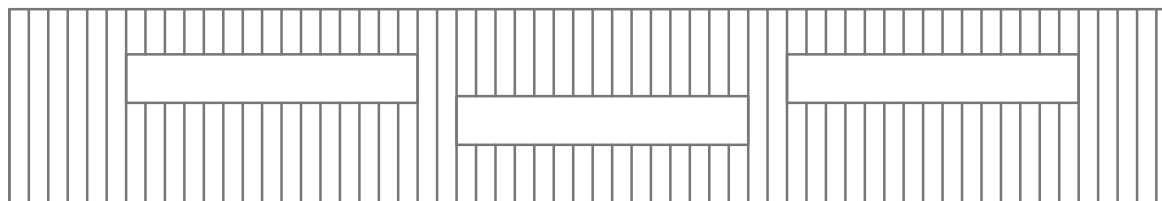
Figur 10. Idéskiss för utformning av bullerskyddsskärmens utformning av genomskinliga partier förbi jätteek. Genomsiktliga partier ska utföras fågelsäkra med ickereflekterande glas och vertikala streck enligt rekommendation från trafikverket. Eftersom genomskinliga partier inte ska placeras nära vegetation ska föreslagen utformning och placeringen stämmas av med fågelexpert
