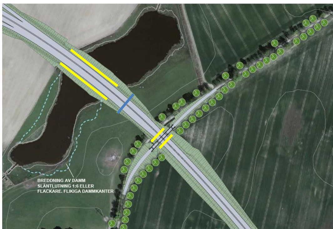
Figur 70. Illustration på åtgärder vid dammen och Håkanstorsbron. Gul linje visar föreslagen placering av bländskydd, blå linje visar torrtrumma och gröna prickar visar återplantering i Håkanstorsallén. Observera att placering av åtgärder är ungefärliga.
