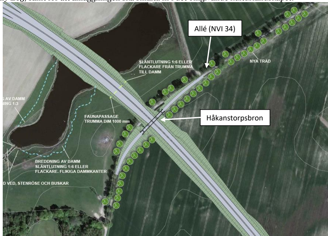
Figur 15. Öster om trafik-/rastplats går Håkanstorpbron över ny E65. Håkanstorp allén förstärks genom plantering i befintliga luckor. Observera att placering av markeringar är en illustration.
