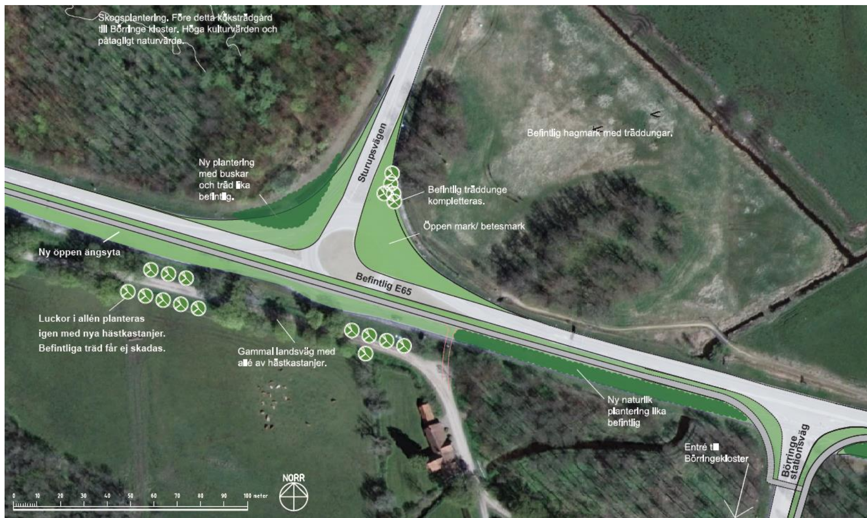
Figur 22. Översikt befintligt E65 och väg 813 (Sturupsvägen). Ny trevägskorsning och föreslagen nyplantering. Återplantering som kompenserar avverkning på allén vid Fjällfotavägen och allén vid Perstorps gård.
