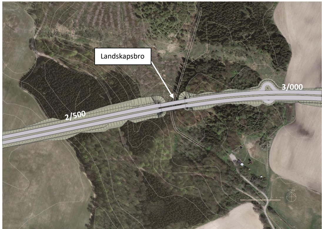
Figur 13. Placering för vägbro över ravinen utformad som landskapsbro väster om väg 813 (Sturupsvägen).
