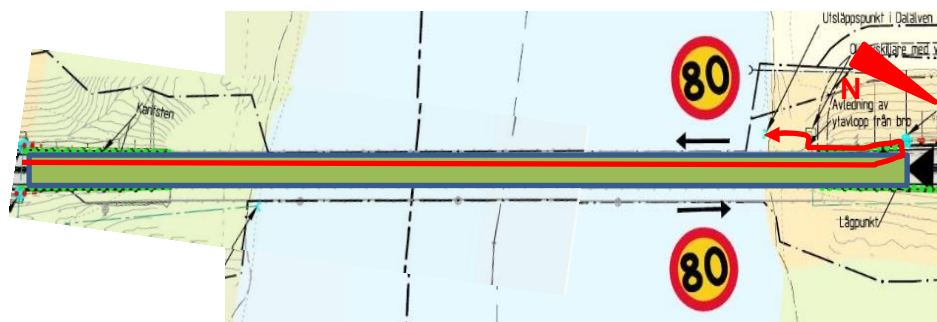
Figur 15 Översikt över område D. Längsta rinnsträckan anges i rött, kantsten grönprickigt, intagsbrunn i dike ljusblå.
