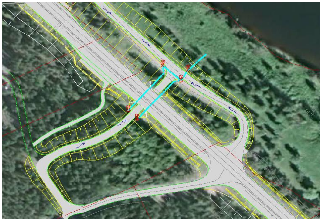
Figur 21 Översiktlig skiss på vägåtgärder samt föreslagen avvattningslösning.
