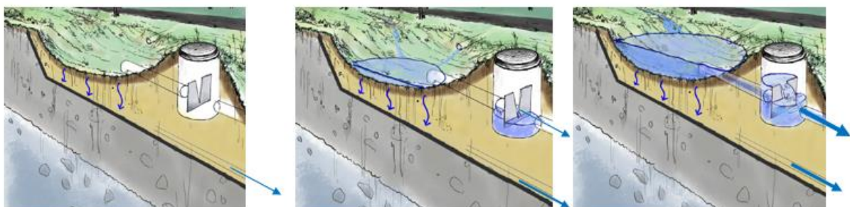
Figur 19: Principiell funktion på utjämningsmagasin med flödesutjämnning.
