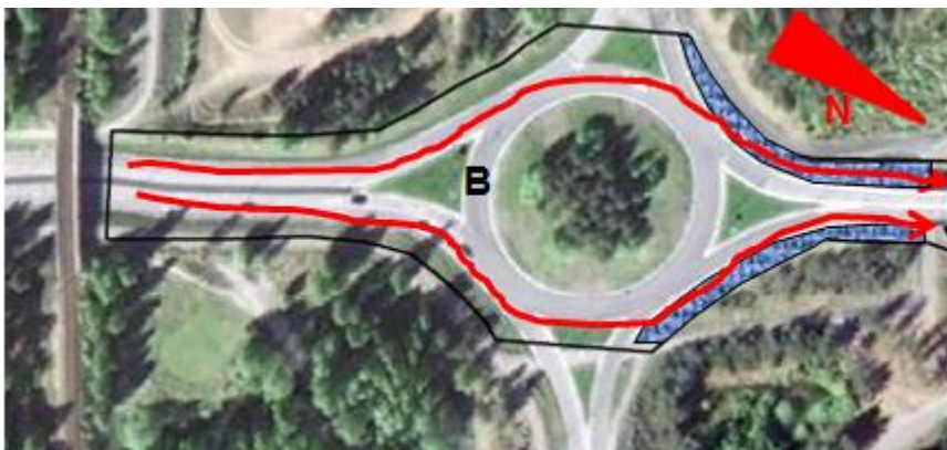
Figur 12 Område B i svart, den längsta rinnsträckan i rött. Utbredning av framtida täta diken i blått.
