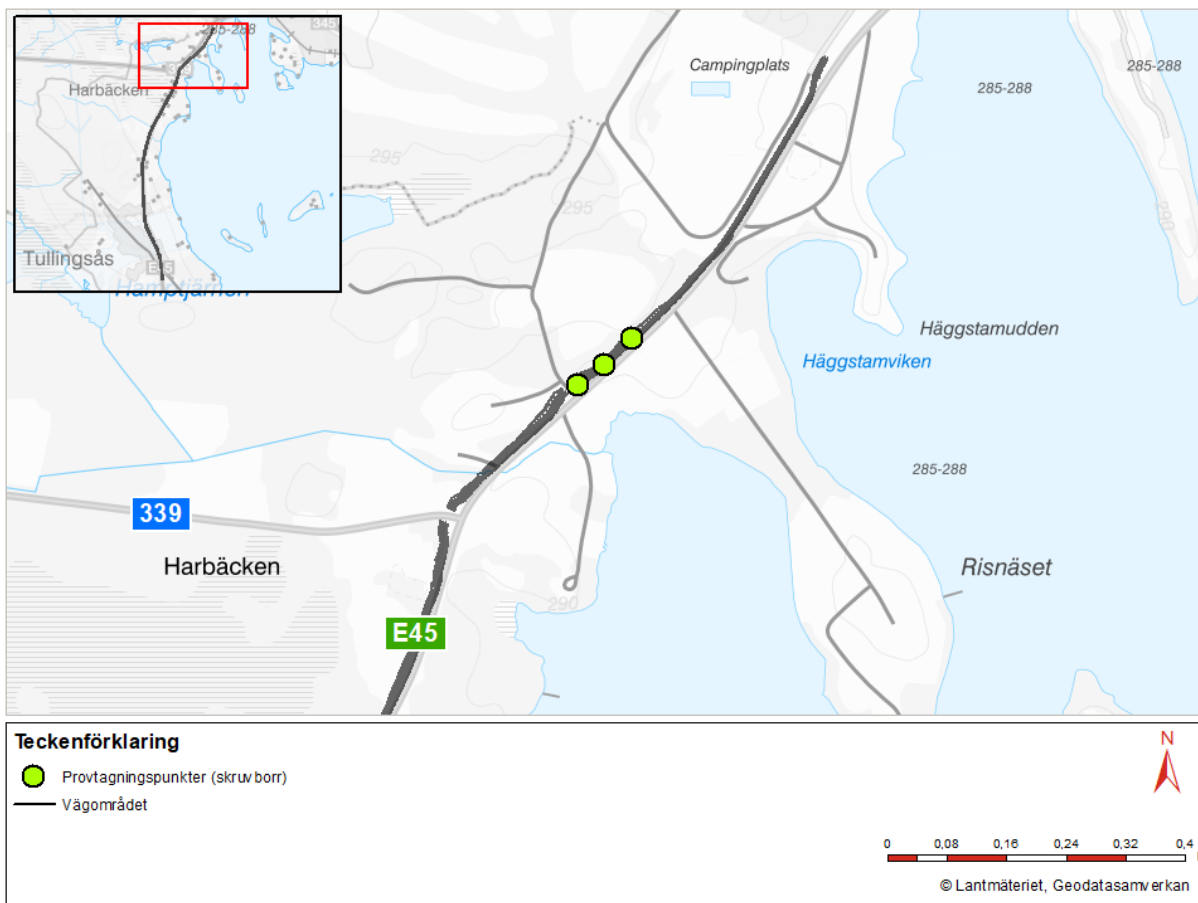
Figur 4.5:8 – Sex jordprover uttogs ur tre provpunkter med skruvborr.
