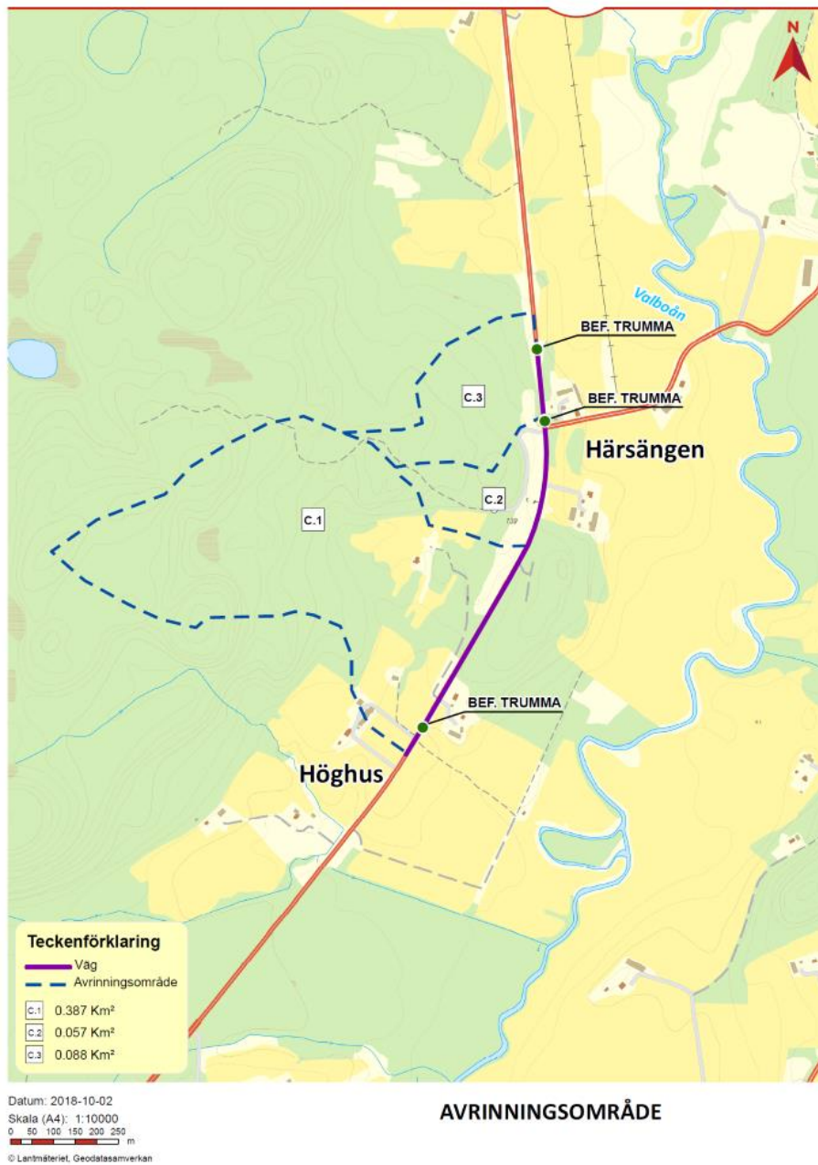
Figur 4.3-1. Tre mindre avrinningsområden som korsas av den befintliga väg 172 vid Härsängen samt tillhörande rörtrummor, en för varje avrinningsområde. Vattnet i rörtrumorna leds österut, mot Valboån.
