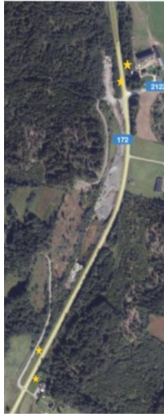
Figur 6.6-2. Placering av uttag av ytvatten i diken och platser för uttag av delprover till vägdikesprov. Bilden är placerad i norr-söderläge.
