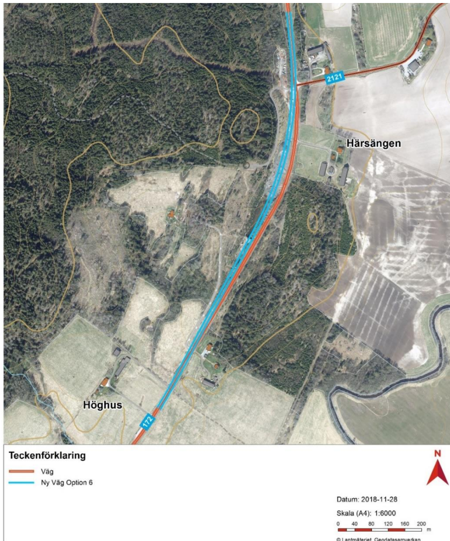
Figur 6.2-1. Utformningsalternativ 6, den nya vägsträckan visas i blått, den befintliga vägen går öster om den nya vägen.
