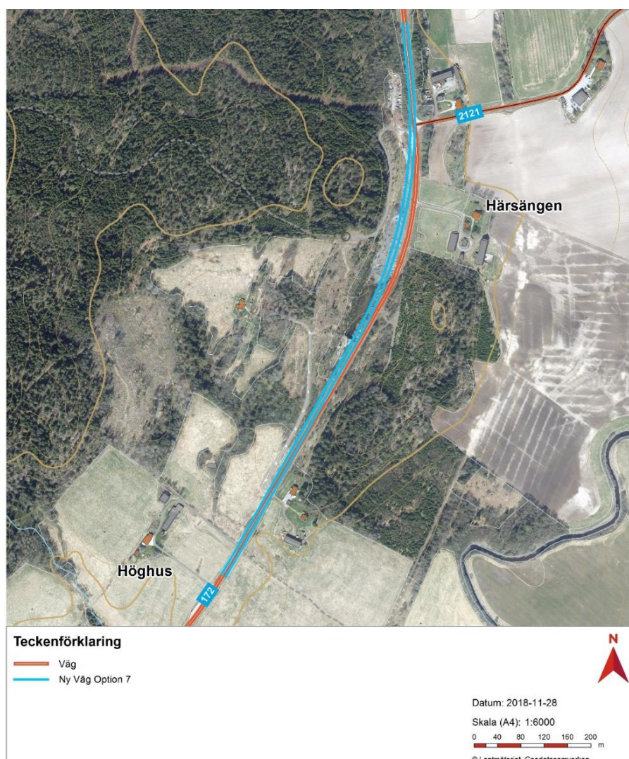
Figur 6.3-1. Utformningsalternativ 7, den nya vägsträckan visas i blått, den befintliga vägen går öster om den nya vägen.
