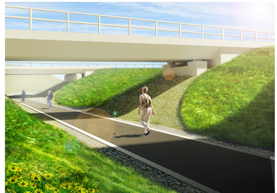
Vy 3: Slänterna utanför regnskuggan planteras med frodig grönnska. Skärmarna på landbro-arna är delvis genomsiktliga, dels för att öka orineterbarheten för biltrafikanterna och dels för att ge broarna ett lättare uttryck.
