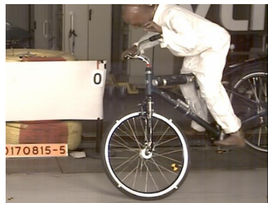
Figur 1b. Framhjulsbromsning utan ABS
