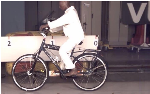
Figur 1a. Framhjulsbromsning med ABS.
