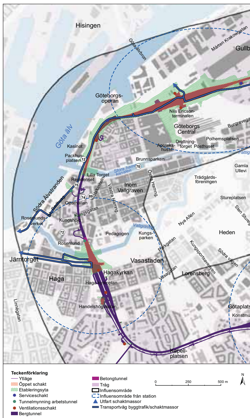
FIGUR 5.3. Anläggningar, ytor och föreslagna transportvägar inom influensområdet för delsträckan Station Centralen-Station Haga
