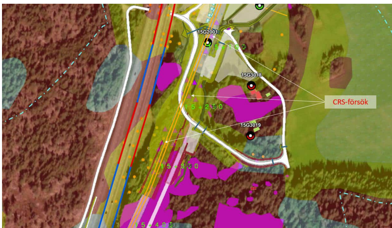
Figur 24. Utförda undersökningar (gröna cirklar, orangea punkter och lila trianglar) vid km 15+200–15+400. Röda cirklar har ej kunnat utföras enligt plan.
