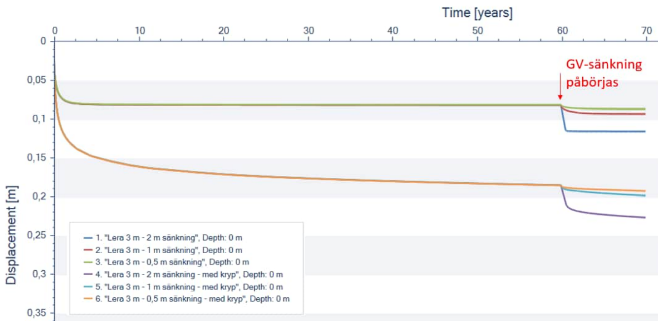
Figur 11. Beräknade sättningar vid fastighet Fredriksdal 2:2>1 för 0,5 till 2 m grundvattenssänkning och 3 m lera. Last från befintlig byggnad 90 kPa – Med och utan krypning.
